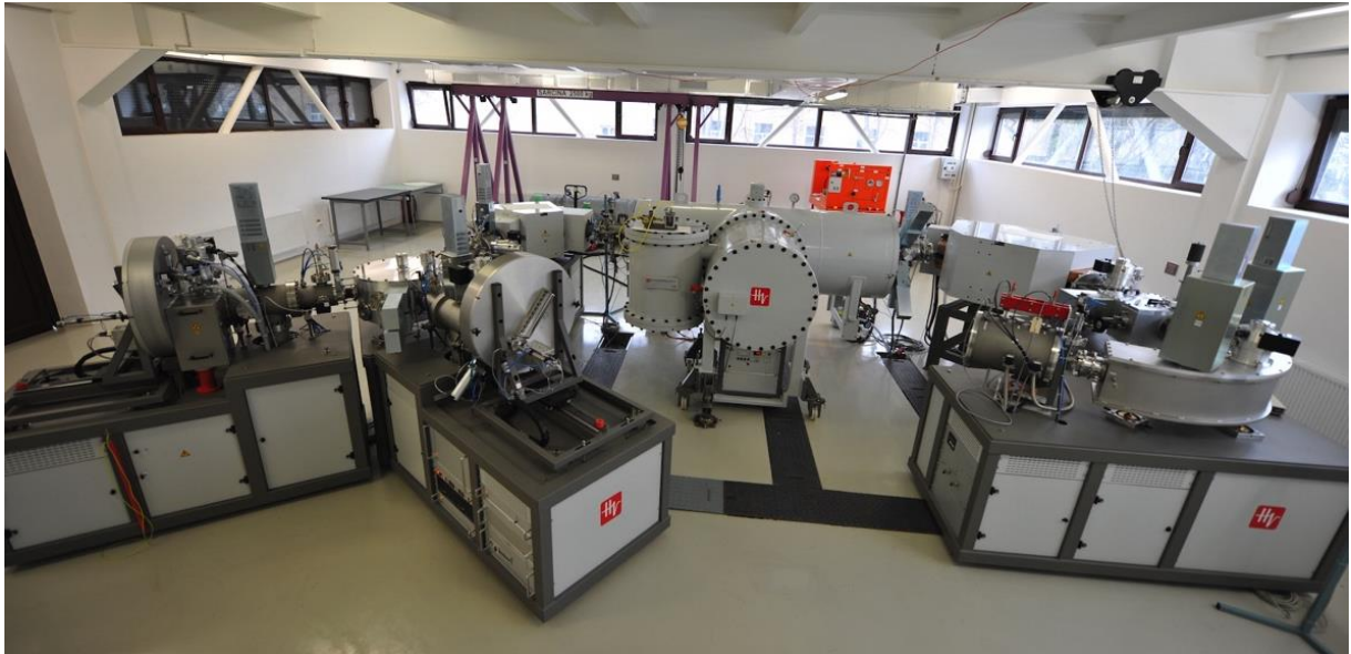
Foto 8. Acceleratorul Tandetron de 1 MV dedicat spectrometriei de masă cu acceleratori
