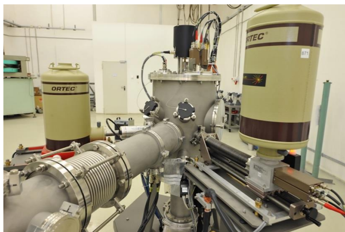
Foto 6. Linia experimentală #1 de la acceleratorul Tandetron de 3 MV dedicată analizelor elementale de mare sensibilitate cu fascicule de ioni
