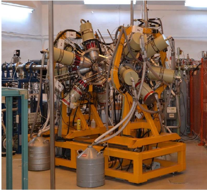
Fig. 2 : Vedere de ansamblu a spectrometrului ROSPHERE.
