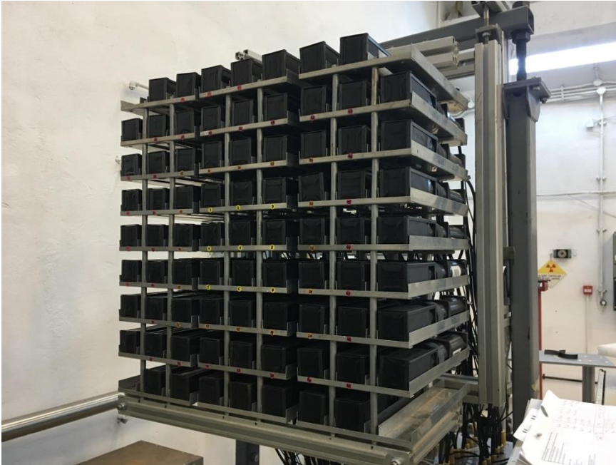
Fig. 5: Sistem multi-modular de detecție a neutronilor compus din 81 de scintilatori de plastic.
