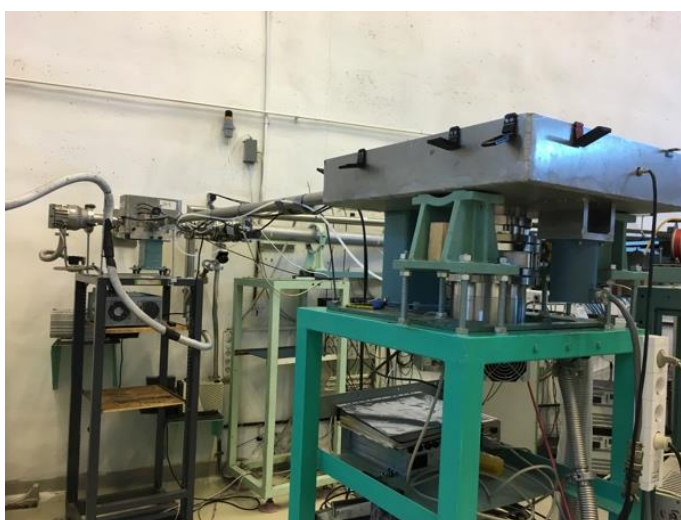
Fig. 4. Sistemul de transport al radioactivității pentru experimente de dezintegrare beta în fond redus.
